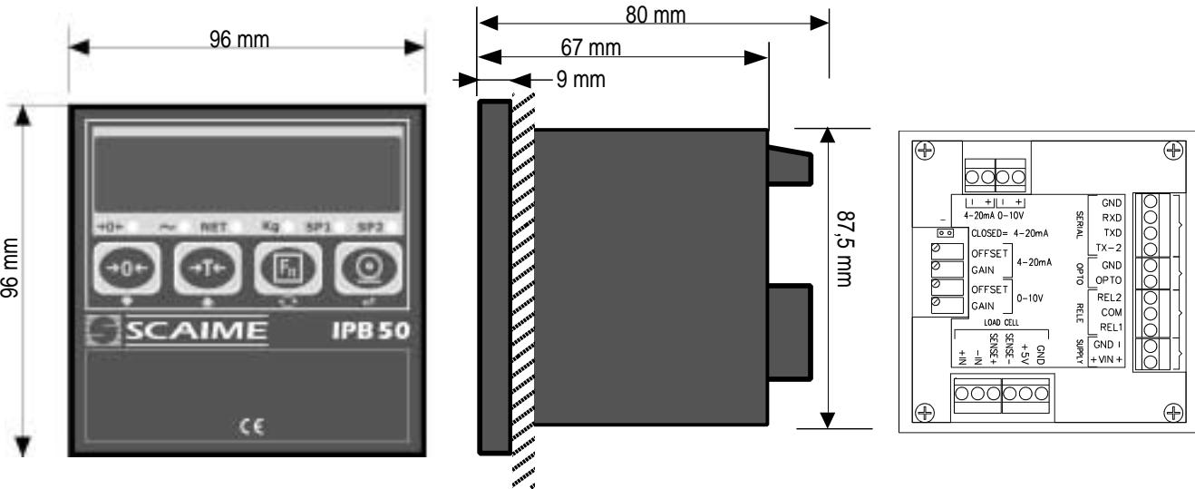
Dimensions de perçage : largeur 91 mm x hauteur 89 mm - Drilling template : 91 mm width x 89 mm height
